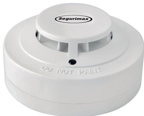
O Detector de Temperatura endereçável Compact é adequado para monitorar ambientes com presença de materiais, cuja característica no início da combustão é gerar muito calor e pouca fumaça. Também é indicado para ambientes com vapor, gases ou muitas partículas em suspensão, onde os detectores de fumaça estão sujeitos a alarmes falsos. O detector dispara quando for ultrapassado o limite de  $57 \pm 3^\circ\text{C}$ .
