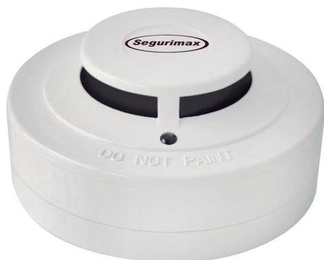
O Detector de Fumaça Endereçável Compact foi projetado detectar a presença de fumaça no ambiente e enviar um sinal para a central endereçável Compact Segurimax. Seu componente sensor é uma câmara óptica que detecta partículas de fumaça produzidas por diversos tipos de materiais combustíveis. É adequado para instalação em diversos ambientes, como prédios comerciais e residenciais, ambientes de recreação, hospitais e escolas.
