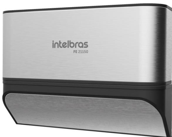
Indicada a portas que abrem para dentro, a FE 21150 D utiliza como princípio de funcionamento a força de tração magnética de 150 kgf. Com estrutura e suportes feitos em aço, e tampa de proteção em ABS reforçado com revestimento em inox, o produto é leve, tem alta resistência à corrosão e baixo magnetismo residual.
