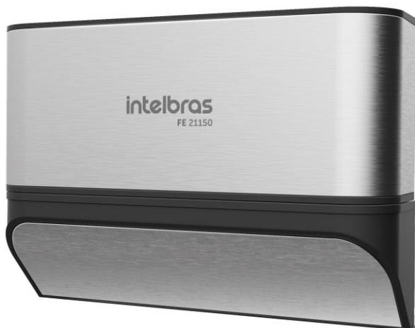
Indicada a portas que abrem para dentro, a FE 21150 D utiliza como princípio de funcionamento a força de tração magnética de 150 kgf. Com estrutura e suportes feitos em aço, e tampa de proteção em ABS reforçado com revestimento em inox, o produto é leve, tem alta resistência à corrosão e baixo magnetismo residual. Este modelo possui sensor para detectar que a fechadura está magnetizada e a porta fechada.
